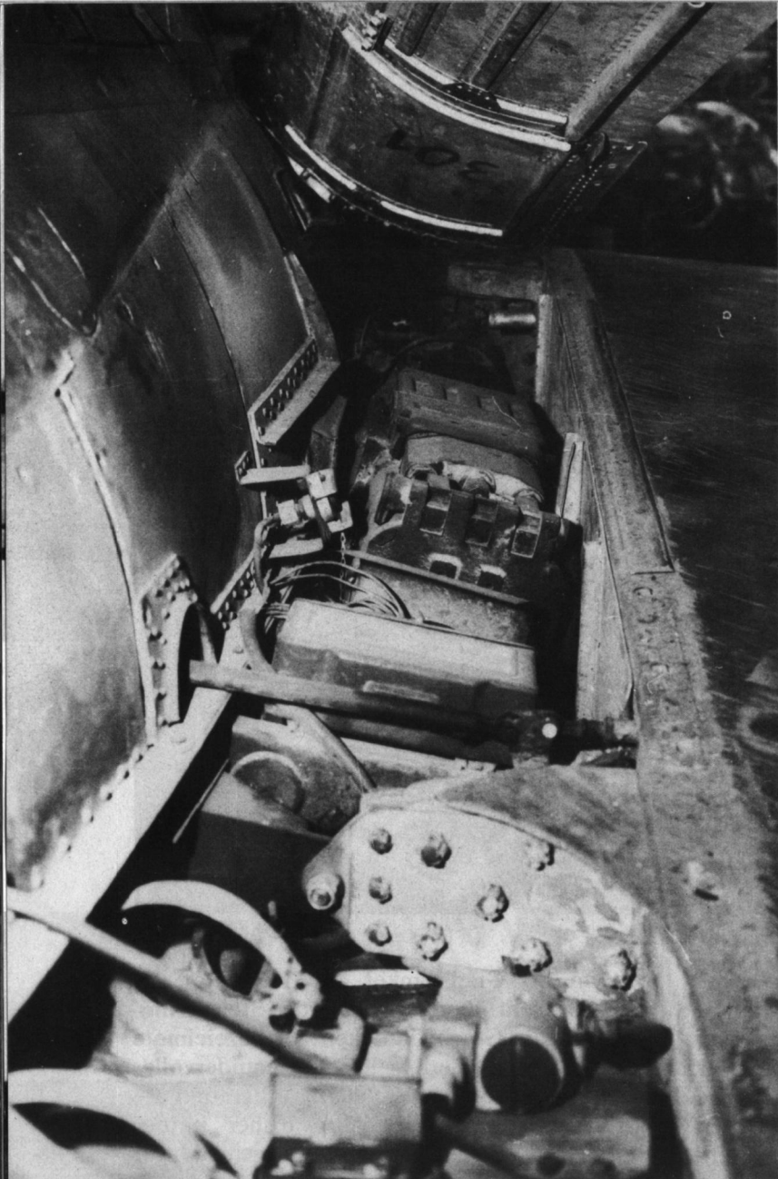
Oben: In Flugrichtung gesehen. Die Verkleidungsbleche an der Flügelwurzel sind entfernt und geben den Blick auf die Maschinenwaffe frei.
